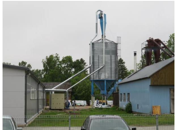
Foto 27 Puidu tootmisterrituumi tsüklon koos aspiratsiooniseadmega
