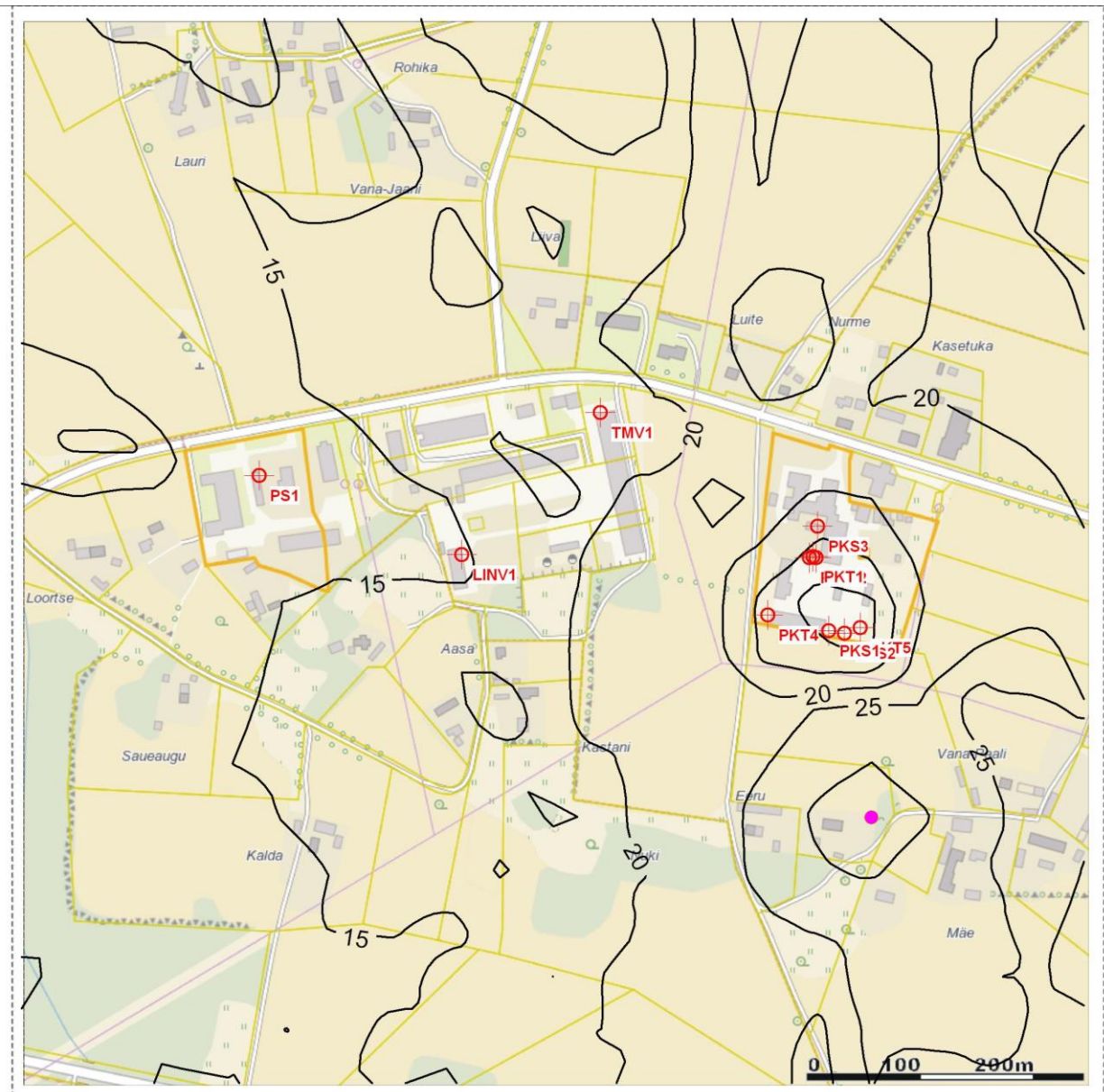
Joonis 16 OÜ Novara heiteallikatest maapinnalähedased NO x kontsentratsioonid, 1 tunni keskmised väärtused, µg/m 3 . Maksimaalse kontsentratsiooni tekkimise asukoht tähistatud lilla punktina.
