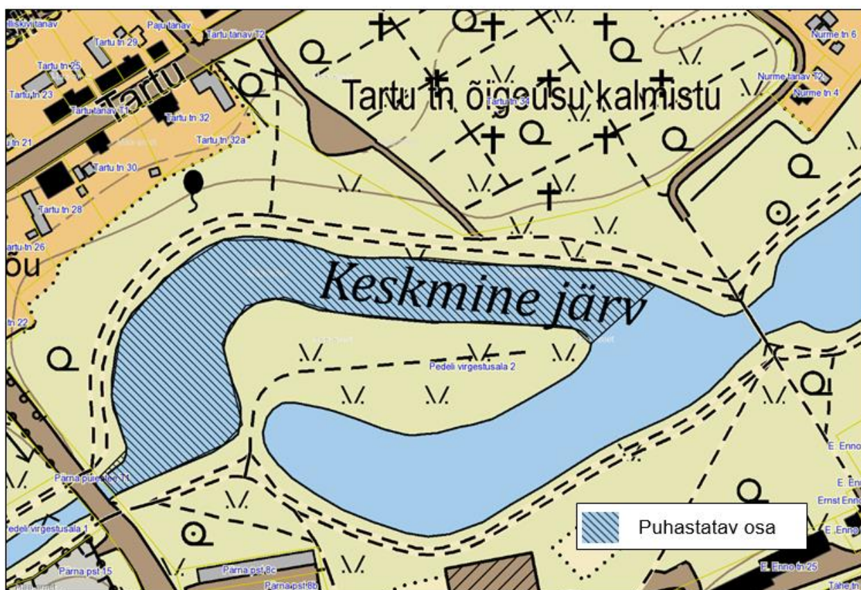
Joonis 5. Teise paisjärve (Keskmise järve) ligikaudne setetest ja taimestikust puhastatav osa (aluskaart: Maa-ameti kaardirakendus, 2021).
