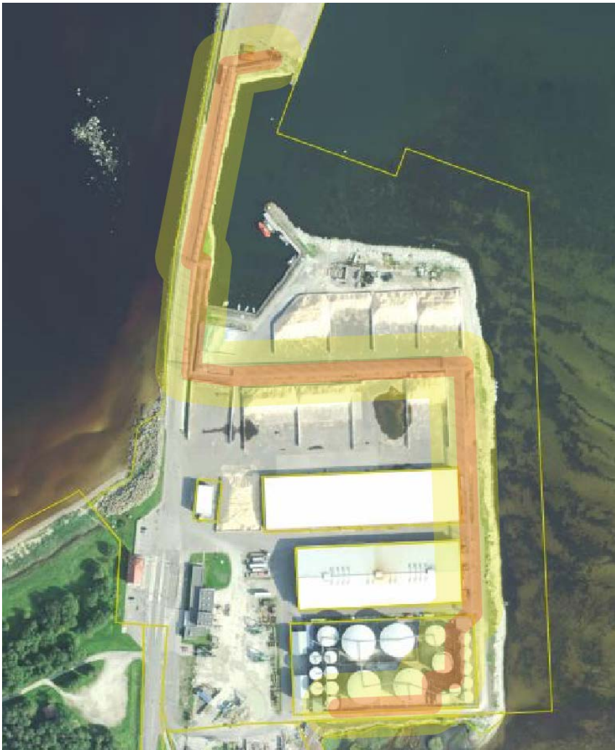
Skeem 5. Produktorust lekkinud põlevvedeliku ohualad ehitistele: 10 m ja inimelule: 30 m.
