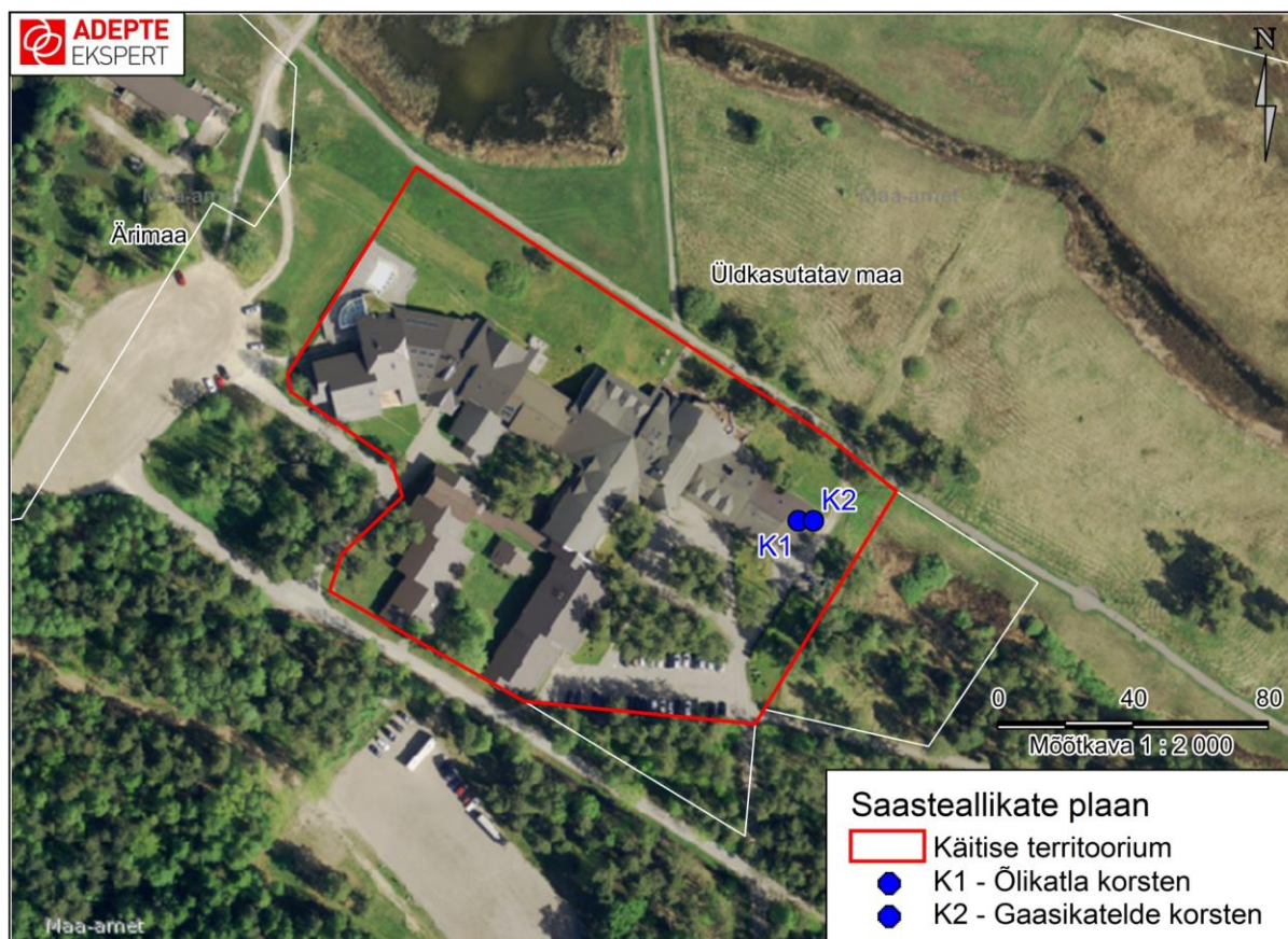
Joonis 2. Käitise asendiplaan. Esitatud on kinnistu territooriumi piir ja saasteallikad. Saasteallikad on plaanil tähistatud numbritega K1, K2. Joonise alus: Maa-amet X-Gis.
